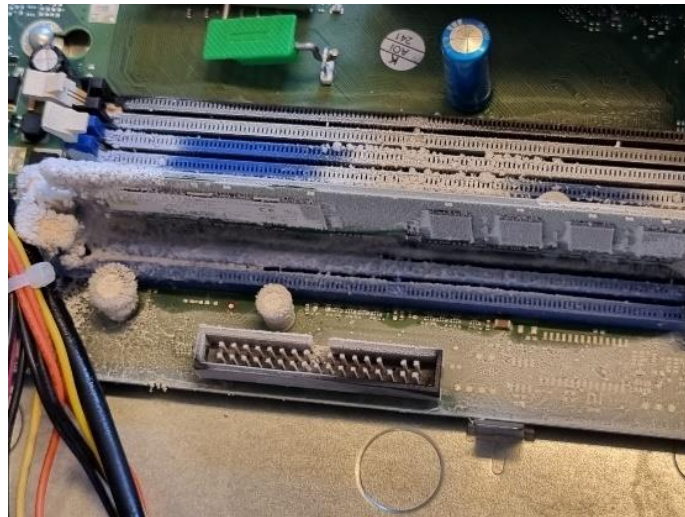
Abbildung 8: Cold Boot - eingefrorener DDR2 Speicher
