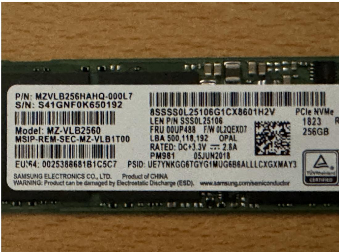
Abbildung 31: Datei-Aufnahme Typenschild SSD
