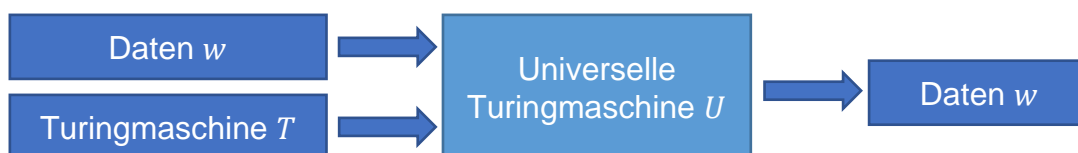
Bild 3 Schematische Darstellung einer universellen Turingmaschine U mit Ein- und Ausgabeparametern.
