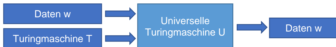
Bild 2.1 Schematische Darstellung einer universellen Turingmaschine U mit Ein- und Ausgabeparametern.
