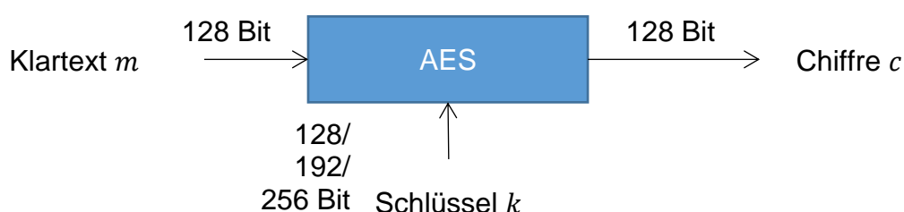
Bild 8 AES ist ein Block-Chiffre Verfahren, welches 128 Bit Blöcke verschlüsselt und Schlüsselgrößen von 128, 192 sowie 256 unterstützt [9, p. 105].
