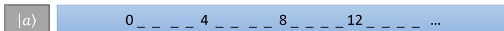
Bild 30 Zustand des Registers a nach Durchführung der QFT, welche den Offset o entfernt hat und nur noch ein Vielfaches der Periode r als 1/r im Register belässt.
